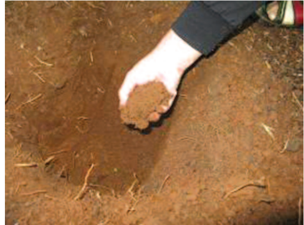
Dùng dao gạt đất, tạo mặt thẳng đứng ở một phía của thành hố
